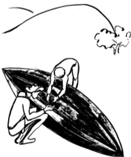
Поломанные шпангоуты заменяются новыми, сделанными из подходящих заготовок на трубогибочном станке.
